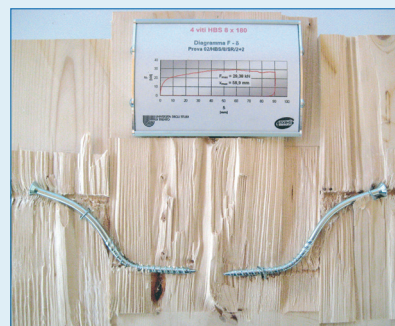
Épreuve expérimentale sur une connexion avec vis soumise à forces de cisaillement (Université de Trento)
