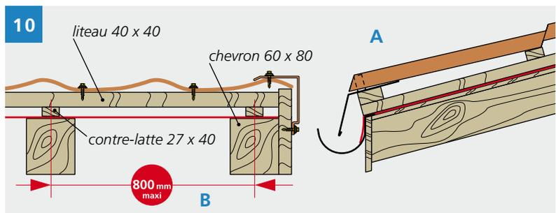
■ **pose des accessoires : attention ! le raccord bris de gouttière se fixe avant les panneaux (dessin 10-A), avant la rive en pignon (dessin 10-B).**
