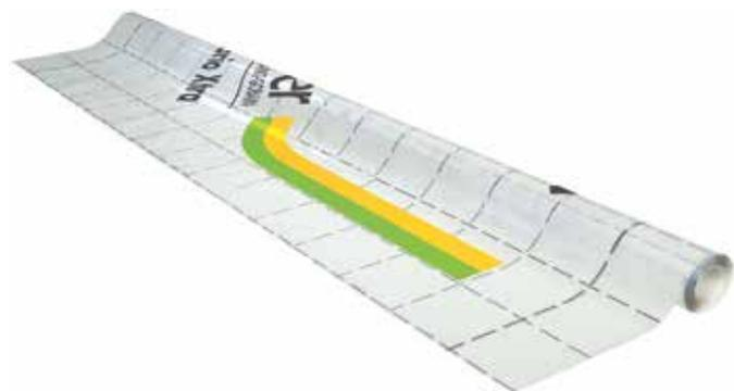
Membrane composée d'un film quadrillé à base de polymère contrecollé sur un voile non tissé, dont la résistance à la diffusion de la vapeur d'eau (Sd) varie en fonction de l'humidité relative, entre 0,4 m et 25 m. Elle est quadrillée pour faciliter la découpe et la mise en œuvre.
