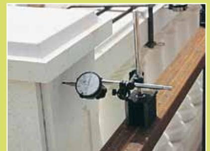
Lorsque la balustrade joue le rôle de garde-corps, elle doit présenter une résistance définie par la norme NF P 01-013 «Essais des garde-corps».
