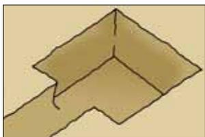
1. Creuser un trou et une tranchée dont les dimensions seront 10 cm plus larges que l'élément à poser. Prévoir une profondeur d'environ 40 cm minimum. La fondation doit être hors gel. Sa profondeur peut donc varier suivant la région ou la nature du terrain. Pour un portail, relier la fondation des piliers par une semelle filante.
