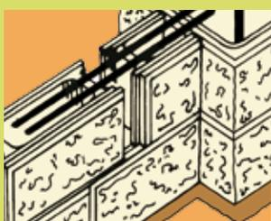
Assembler les murets comme les piliers. Poser des armatures horizontales toutes les 2 rangées en prenant soin de les ancrer dans les piliers. Effectuer le remplissage. Les plaquettes de parement s'appliquent directement sur une maçonnerie saine et propre. Elles se posent au mortier-colle Weser-Mix CO par double encollage (prévoir 5 kg/m<sup>2</sup>).
