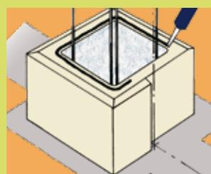
Dans le cas du pilier Chambord, on peut également réaliser des joints minces au mortier-colle blanc. Ce pilier reçoit différent type de bases selon la position du portail et du portillon.
