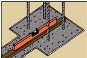
2. Couler la fondation et mettre en place 4 aciers,  $\varnothing$  8 ou 10 mm. S'assurer que l'entraxe des aciers permet le passage du pilier et laisse un enrobage suffisant autour des aciers, soit 3 cm environ. Mettre de niveau.
