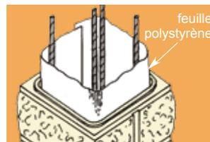
4. Superposer les éléments en alternant les joints verticaux. Disposer des feuilles de matériau compressible de 2 à 4 mm environ, type polystyrène ou mousse de polyéthylène, le long des parois intérieures du pilier. Ces feuilles évitent les risques de fissurations dues aux écarts de dilatation. Les éléments de piliers Tradition sont pré-munis de ce matériau compressible.
