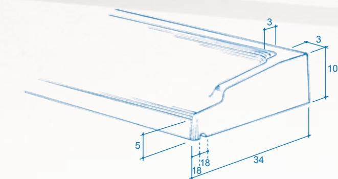
Les appuis Tradition respectent les DTU 20.1/36.1/37.1 et sont conformes à la Norme NF P 98-052 " Appuis de fenêtre préfabriqués en béton ". Ils permettent d'assurer l'étanchéité des menuiseries conformément au Cahier CSTB n° 8183 " Menuiseries en PVC faisant l'objet d'un Avis Technique ".
