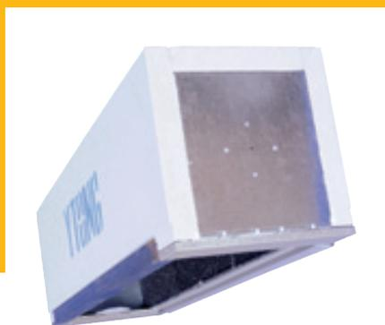
Le coffre tunnel pour volet roulant en Thermopierre est un élément autoportant. Il est armé. Il se pose comme un simple linteau non porteur lors de l'élévation du mur en Thermopierre.
