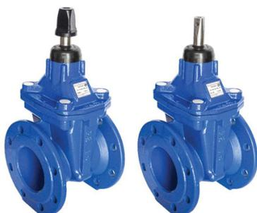
Les robinets-vannes EURO 20 NEW sont des appareils de sectionnement à opercule surmoulé d'élastomère pour des diamètres DN40 à 400 et connexion au réseau à brides destinés à être utilisés en position tout ou rien jusqu'à PFA 16 bar.
