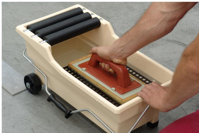
Ce bac de lavage permet d'éliminer l'excès de produit de joint pendant la phase de jointoiment. Construit avec un plastique ultra-robuste, il a une grande capacité de 20L.
