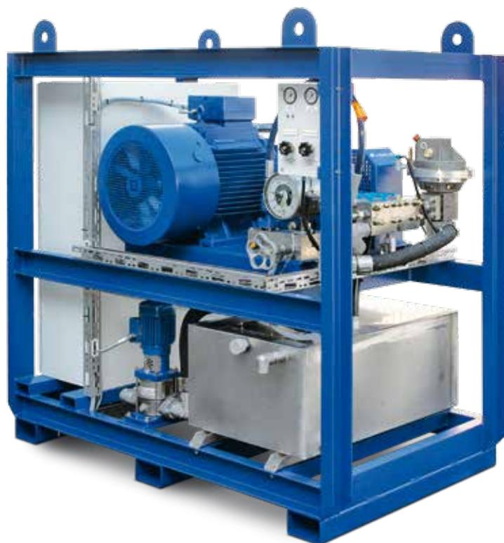
Groupe motopompe d'épreuve DP3-10 E/1000 avec bac de remplissage et pompe centrifuge de gavage, l'ensemble monté sur skid
