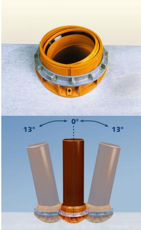
L'angle autorisé par la rotule doit être utilisé jusqu'à 5°. Les 8° restants servent de réserve pour compenser les différents mouvements d'assise du tuyau afin de conserver un raccordement flexible dans le temps.
