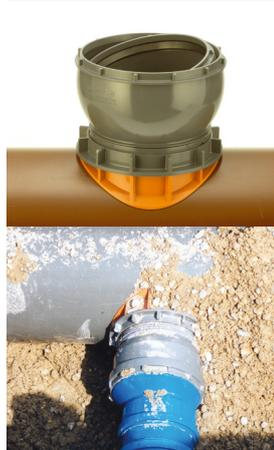
Le raccord de piquage CONNEX permet un raccordement simple et rapide et offre une angulation jusqu'à 11°. Il s'adapte sur les tuyaux lisses à parois minces les plus courants d'une épaisseur de 3 à 15 mm.
