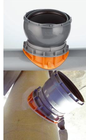
Le raccord de piquage CONNEX permet un raccordement simple et rapide et offre une angulation jusqu'à 11°. Il s'adapte sur les tuyaux lisses à parois minces les plus courants d'une épaisseur de 4 à 31,8 mm.
