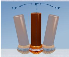
L'angle autorisé par la rotule doit être utilisé jusqu'à 5°. Les 8° restants servent de réserve pour compenser les différents mouvements d'assise du tuyau afin de conserver un raccordement flexible dans le temps.
