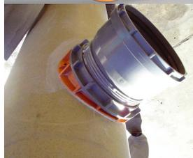
Le raccord de piquage CONNEX permet un raccordement simple et rapide et offre une angulation jusqu'à 11°. Il s'adapte sur les tuyaux lisses à parois minces les plus courants d'une épaisseur de 4 à 31,8 mm.
