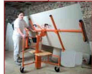
PASSAGE DANS UNE PORTE DE 0,73 M SANS REPLIER LE PIÈTEMENT.
