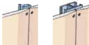
Au droit d'un joint de plaques les vis doivent se trouver face à face.
