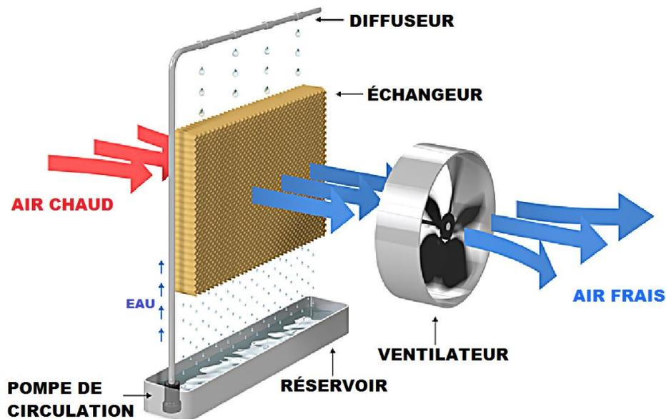
Le rafraîchisseur d'air doit être installé dans un endroit sec et bien aéré pour garantir un renouvellement d'air satisfaisant dans la pièce.
