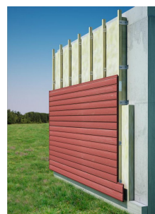
Mise en place d'un pare-pluie
