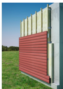
Mise en place d'un pare-pluie
