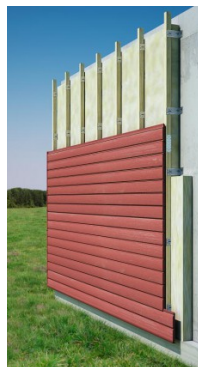
Mise en place d'un pare-pluie
