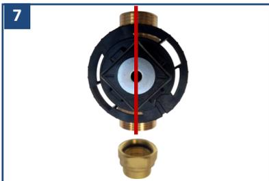
7 Au montage du support tabernacle, aligner la diagonale du carré de manœuvre sur l'axe de la sortie du robinet de manière à accoupler l'axe sur la sphère. Le maintenir dans cette orientation jusqu'au vissage complet du support tabernacle
