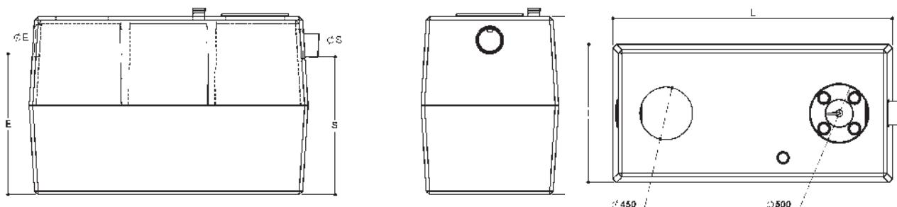
Séparateurs de catégorie 1D: installation hors passage de véhicules et absence de nappe phréatique. Remblai supérieur de 50 cm maximum.
