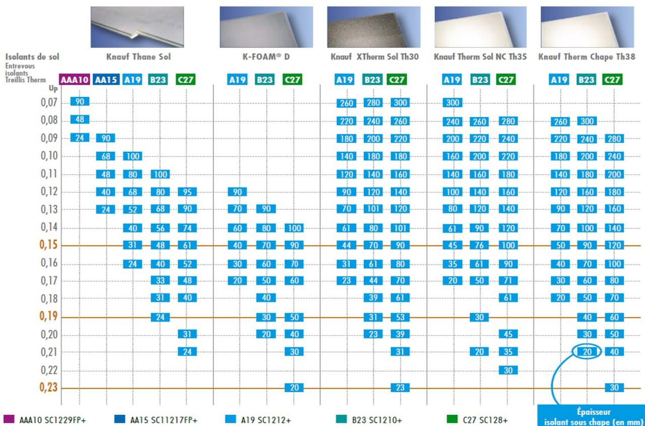
(1) Performances thermiques des Treillis Therm SC... associés à des poutrelles treillis de talon de 120 mm.
